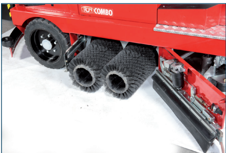
De cilindrische borstels met tegengestelde draairichting kunnen tegelijk vegen en schrobben
