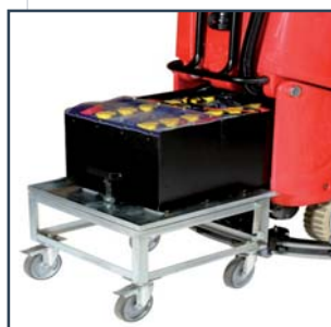
4 BATTERIES 6V-240 Ah (20h) À REMPLACEMENT RAPIDE 4 BATTERIJEN 6V - 240 Ah (20h) MET SNELLE VERVANGING
